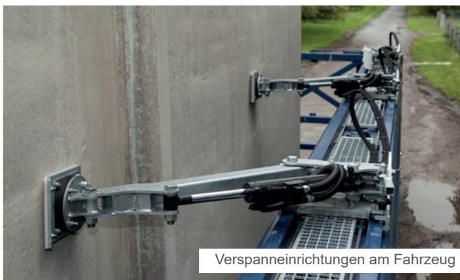
Es sind ausreichend Arretierungselemente bereitzustellen. Diese sind gegen Verlust zu sichern. Zur Ladungssicherung gehören daneben **Abstandhalter** und **Verspanneinrichtungen** (Pratzen) sowie **rutschhemmende Matten**. Bei den Pratzen gibt es kraft oder manuell betätigte.
