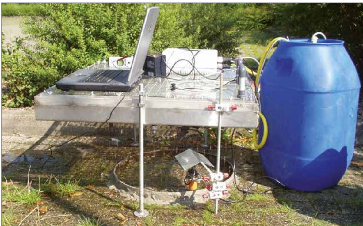
Versickerungsmessung an einer Bestandsfläche mittels Tropfinfiltrimeter.
