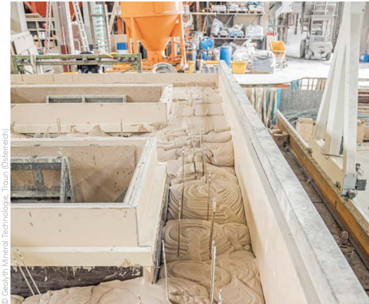
Bild 6: Neuartige Fassadenbauteile mit Mineralschaumdämmung, Zuber Beton.
