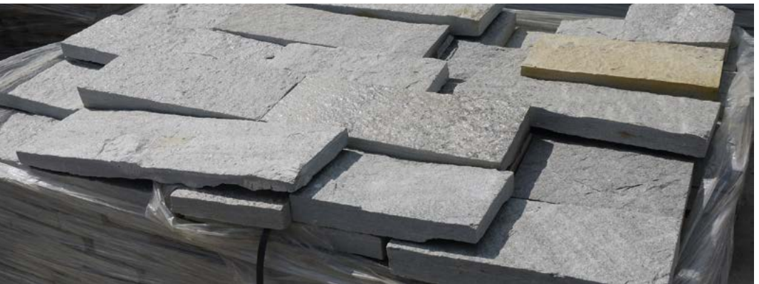
Abbildung 1: Fußbodenplatten aus Dörler Gneis – In Dörfel werden nicht nur gebrochene Gesteinskörnungen, sondern auch Naturwerksteine für unterschiedliche Einsatzbereiche hergestellt (Foto: UVMB).
