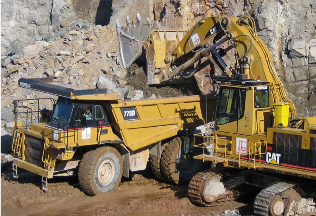
Abbildung 3: Verladung des gesprengten Haufwerks auf Muldenkipper.
