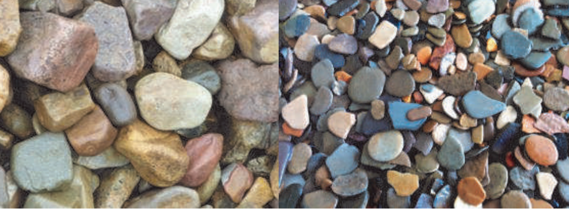
Abbildung 2: Bereits optisch unterscheiden sich die einzelnen Kiese nach ihrem Liefergebiet bzw. den Bedingungen zum Zeitpunkt der Ablagerung; links: bunte Kiese aus dem Elbe-Gebiet; rechts: bunte Kiese aus der Helme-Niederung, die überwiegend aus plattigen, teilweise schiefriigen Geröllen aus dem Harz und dem Kyffhäusergebiet bestehen.
