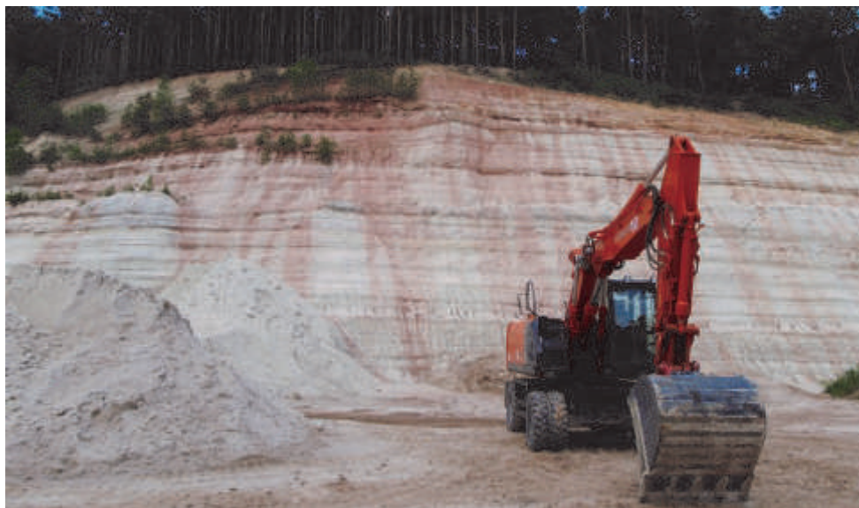
Abbildung 7: Abbau von mürbem Unterem Buntsandstein in Lausitz bei Pößneck.
