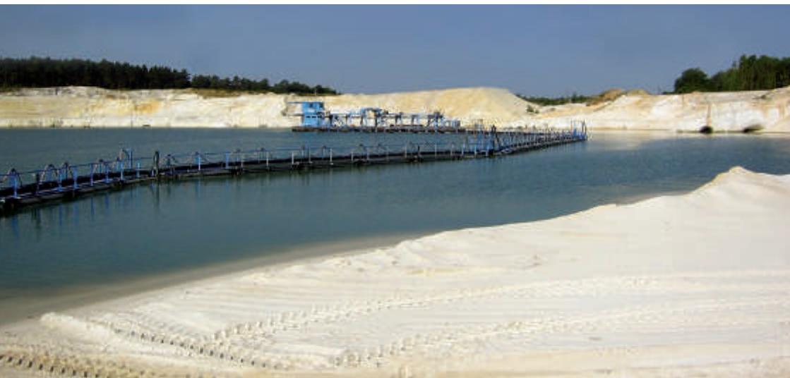
Abbildung 2: Gewinnung von hochwertigem Quarzsand durch Saugbaggerschiff im Quarzsandwerk Uhry der Schlingmeier Quarzsand GmbH & Co. KG (Foto: BGR).
