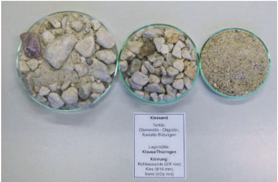
Abbildung 3: Quarzreiche tertiäre Kiessande des Altenburger Flusses aus der Lagerstätte Klausathüringen. Links: Rohkiessand, Mitte und Rechts: aufbereiteter Rohstoff in der Kornfraktion 8/16 Millimeter (Mitte) und in der Sandfraktion 0/2 Millimeter (Rechts).
