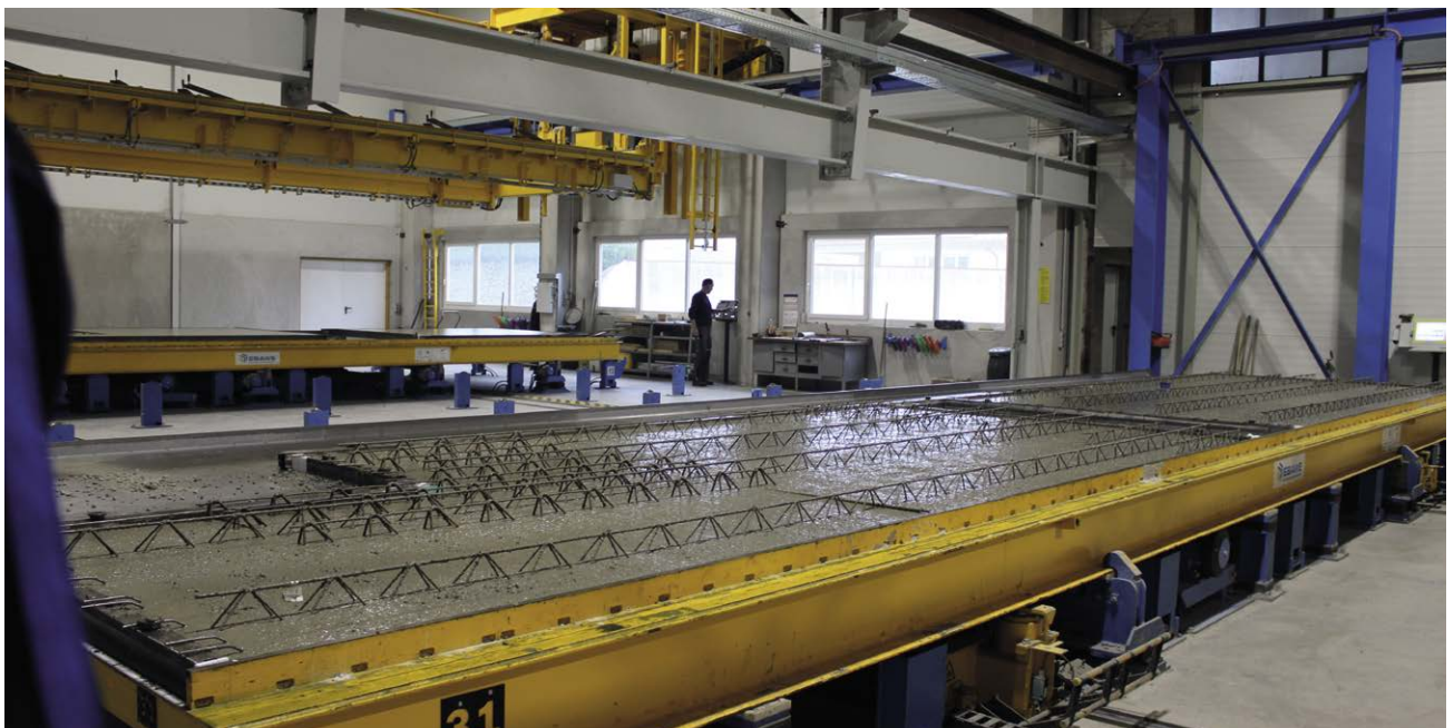
Abb. 1.3: Betonfertigteile werden mit modernen Anlagen wettergeschützt in Werken produziert.
