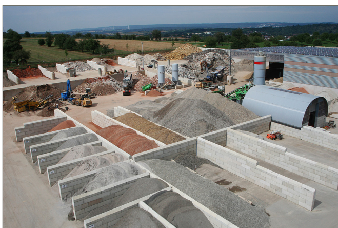
Abb. 6: Baustoff-Recyclinganlage (Im Vordergrund Lager mit verschiedenen Recycling-Produkten, im Hintergrund unterschiedliche mineralische Abfälle (Böden, Ziegel- und Betonbruch), die differenziert aufbereitet werden)
